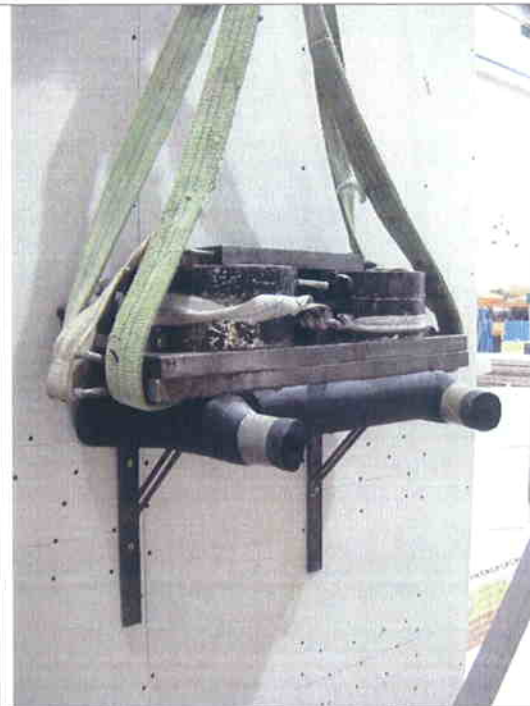
Carga permanente 1000N durante 24h
