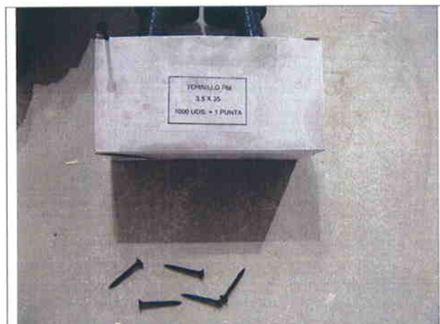
Tornillo tirafondo PM para tabiques de PYL
