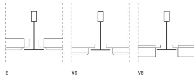
Bandejas conformadas por plegado, fabricadas con chapa de acero galvanizado prelacado de 0,50 mm de espesor. Existe la opción de fabricar las bandejas en aluminio de 0,60 mm de espesor. Todas las bandejas son suministradas con film adhesivo de protección.
