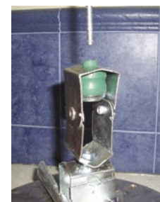
Detalle de la muestra bajo carga de rotura.
