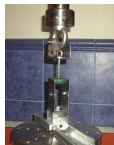
Detalle de la muestra bajo carga de 150 Kg.
