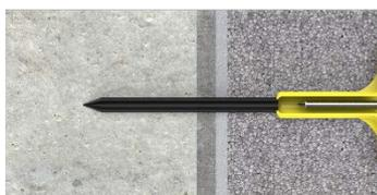
3. Posicionar el núcleo metálico y golpear con un martillo de nylon 2 o 3 veces hasta introducirlo completamente y dejarlo enrasado con la cabeza de la espiga.
