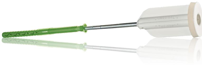
Sistema de fijación para instalación de accesorios a posteriori con cargas ligeras a medias (hasta 15 kg) en fachadas DANOTHERM® SATE que comprende una pieza plástica con junta de estanqueidad para el montaje de accesorios, un adaptador y un taco plástico (Ø 8 mm) con su correspondiente tornillo para el anclado.
