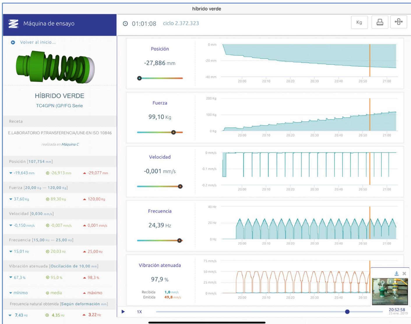
● 1º- La carga sometida a la probeta en este punto es de 99,10 Kg, dividido entre 4 = **24,77 Kg. unidad.**
