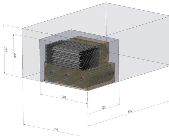
El volumen de embalaje y manipulación se reduce en más de un 60% en comparación con otros anclajes para aislante de una pieza
