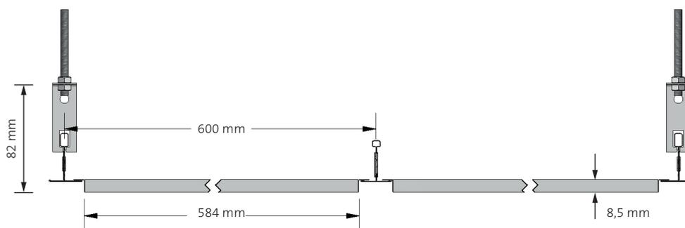
Sistema de montaje: Perfil QUICK-LOCK® T-24 y T-15 semivisto
