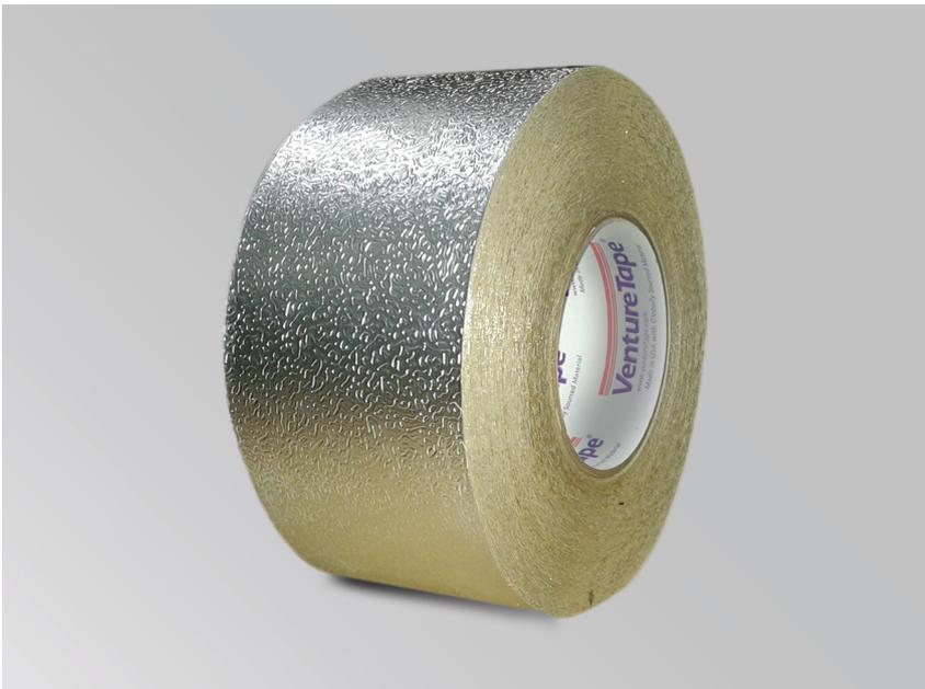
Cinta de aluminio gofrado en base acrílica de 75 mm de ancho y 190 micras de espesor para la realización de conductos autoportantes CLIMAVER® en exteriores de edificios.
