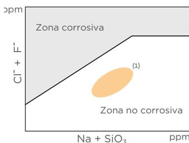
Nota: los análisis químicos de iones demuestran que los productos de lana de roca ISOVER no provocan la corrosión en el acero ya que la relación de iones  $Cl^- + F^-$  respecto a los  $Na^+ + SiO_3^-$  se sitúa en la parte inferior de la Curva de Karnes.
